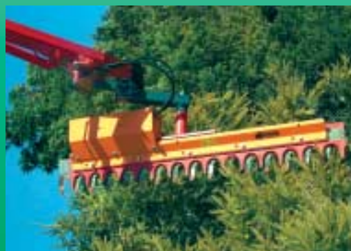
Astscher (Sonderzubehör) Arbeitsbreite 2,20 m; inkl. Verstellzylinder
